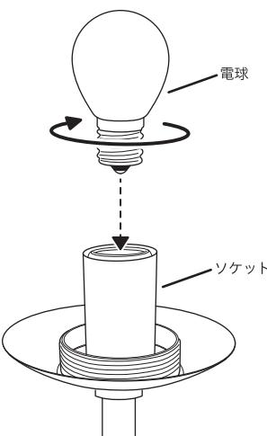
本体のソケット部分に電球を取り付けます。
